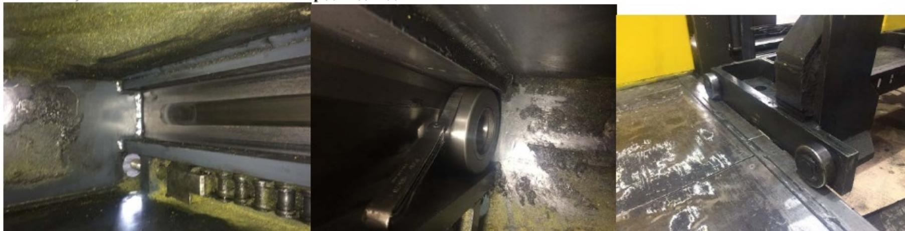
Направляющие с платформой представляют единое целое , толстостенные швеллеры вварены в конструктив опорной рамы, простая отрезка и вваривание новых швеллеров не возможна. Так будет разрушен жёсткий конструктив несущей опорной платформы и при простой сварке будет линейная температурная деформация металла, что поставит под сомнение соблюдение геометрических допусков и зазоров, будет присутствовать кручение, нарушение параллельности ,перпендикулярности и диагональных размеров.
