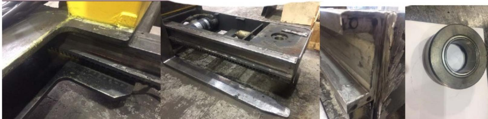
Свободный воздушный зазор на неизношенной части направляющей между установленным подшипником и полкой швеллера составляет не более 0,15мм. На изношено~~й~~й части зазор доходит до 2мм.
