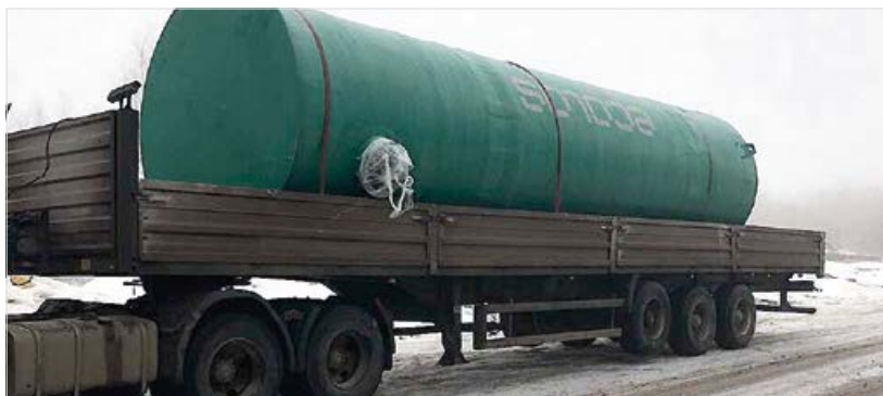
Станция КНС производительностью 150 м³/ч г. Самара. Реконструкция Московского шоссе. 2016 г.
