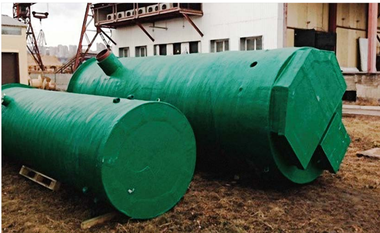
Станция КНС хозяйственно-бытовых стоков производительностью 200 м³/ч. Поставка оборудования, проведение шеф-монтажных и пуско-наладочных работ. Самарская область, г. Чапаевск. 2016 г.
