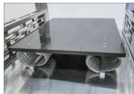
Амортизирующая платформа с резиновыми или тросовыми демпферами
