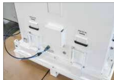
Герметичный контейнер во время проверки избыточным давлением
