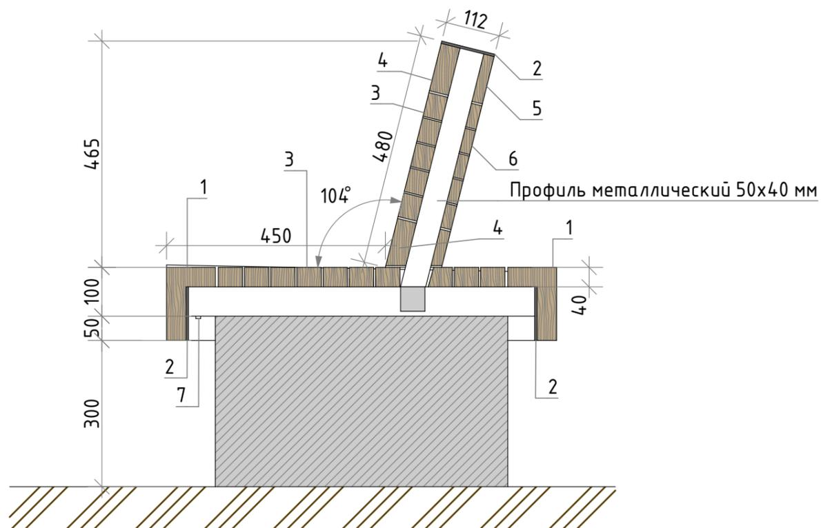
Схема каркаса скамьи тип 1 и 2
