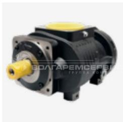
Высокоэффективный одноступенчатый модуль сжатия Rotorcomp, Aertzener или Tamrotor. Роторный блок оснащен системой постоянной циркуляции масла с качественной многоуровневой сепарацией. Применение ассиметричной винтовой группы обеспечивает длительное поддержание стабильного давления с минимизацией потерь и естественных пульсаций. Для увеличения срока эксплуатации конструкция блока дополнена специальными износостойкими подшипниками;
