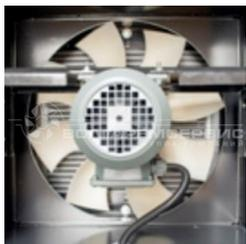
100% эффективное охлаждение. Для интенсивного обдува воздушно-масляного радиатора используется лопастной осевой нагнетатель с автономным электроприводом. Благодаря надежной системе охлаждения и улучшенной вентиляции корпуса, температура сжатого воздуха на выходе из блока всего на 5 - 10°C выше температуры окружающей среды.
