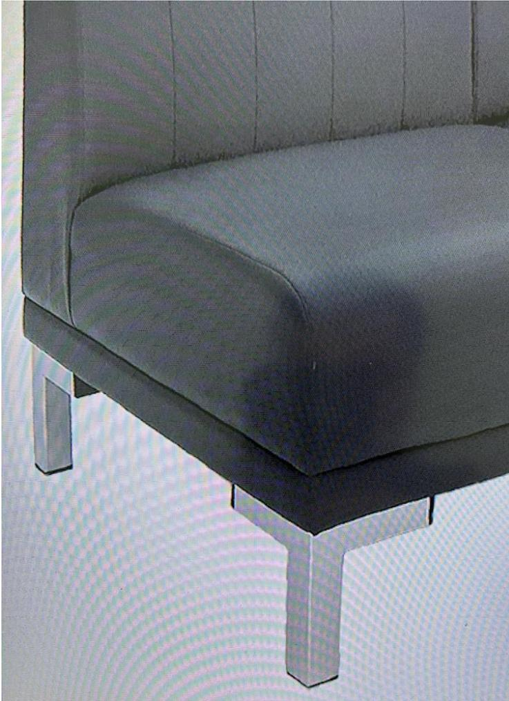
Материал производства труба квадратная (профиль) сечением 40x40 и толщиной стенки 1,2-1,5мм. Покрытие порошковое, серого цвета. Высота ножки 180мм, ответвления по торцевой части и фасаду 150мм из такого же профиля сечением 40x40. По 2 отверстия для крепления на каждом ответвлении. Заглушки пластмассовые.
