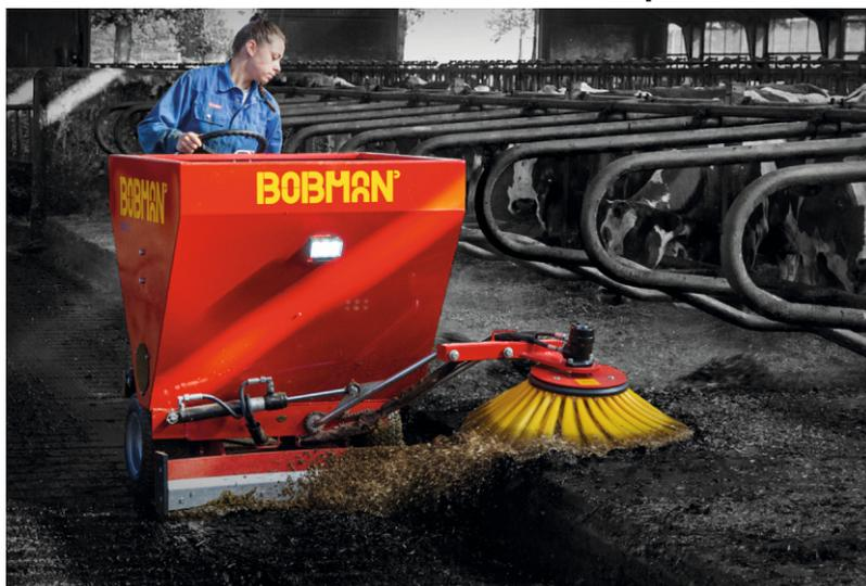
**BOBMAN** облегчает регулярную уборку и уход за столами. Разбрасыватель и щетка чистит зону лежака и распределяет свежую подстилку за один проход. Регулярное удаление инфекционных бактерий во время пополнения подстилки жизненно важно для поддержания низкого количества бактерий. Совместное выполнение этих двух операций приведет к получению качественного молока и увеличению удоев, а также сократит время, необходимое для очистки стойл и повысит эффективность вашей фермы!
