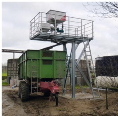
Этот PSS 2.2-400 с питающим баком стоит на свиноферме с приблизительно 5% содержания СВ в навозе. Прицеп-самосвал заполняется сухим материалом примерно через 1,5 дня.
