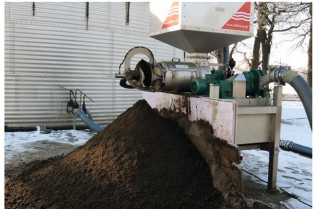
PSS 4-550 установлен на опорах и сепарирует навоз.
