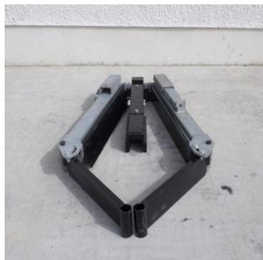
Складные лезвия скребка используются в проходах, где необходим автомобильный доступ. Крылья можно сложить, просто удалив два штифта.
