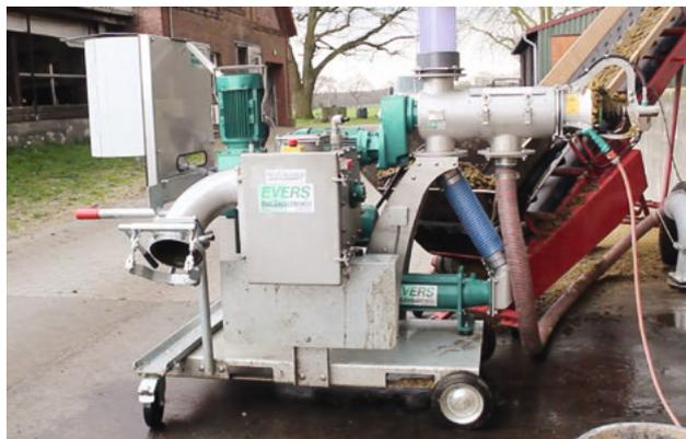
ComPress со встроенным фильтр-измельчителем для защиты насоса, производит подстилку для коров.
