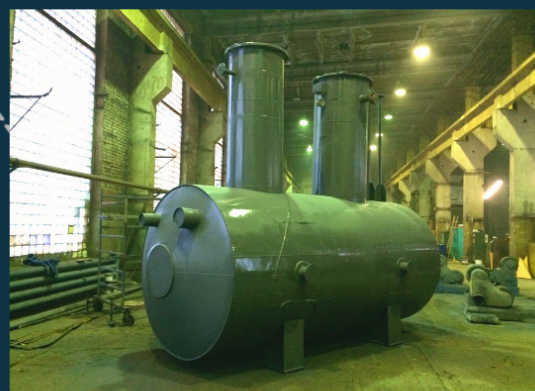
Резервуар горизонтальный подземный стальной (РГСР-25). ПАО «Транснефть» "Форпол Нафта-80"
